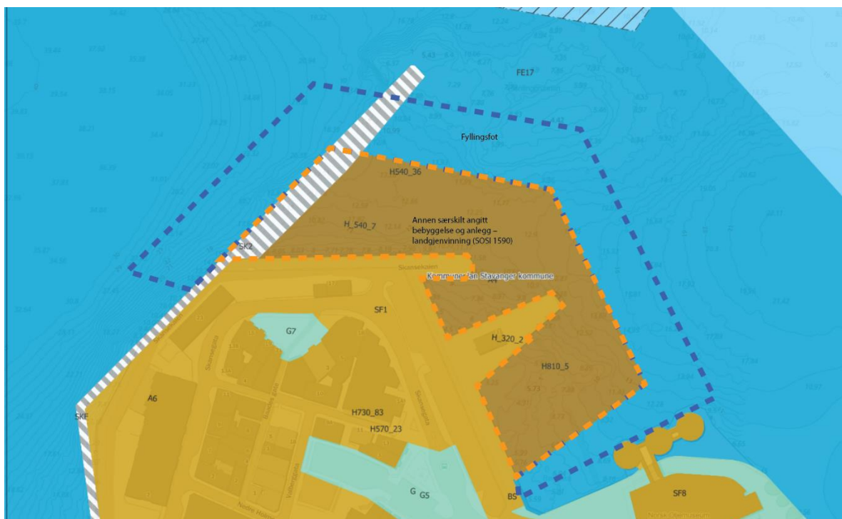
Figur 1: Skisse for regulering av nivå 1 - under grunnen. Oransje stiptet strek viser utfylling under framtidig byggeområde. Blå stiptet strek viser omtrentlig avgrensning av fyllingsfot for planlagt utfylling..
